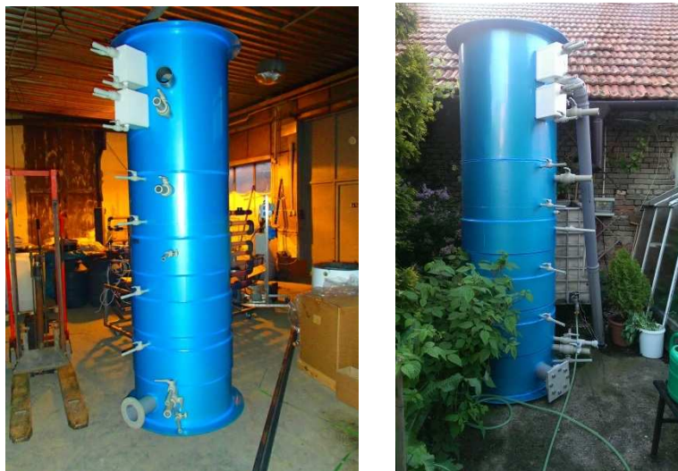
Obr. 4 UASB reaktor připravený pro testování v roce 2014 a instalace na lokalitě
