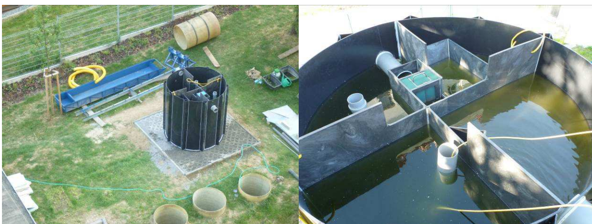
Obr.1 Inovativní septik na zkušebním polygonu v areálu VUT
